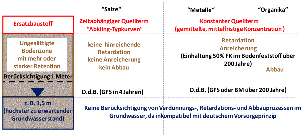
Abb. 1: Rahmenbedingungen und „politisch“ getroffene Konventionen aus dem vorsorgenden Grundwasser- und Bodenschutz für die Ableitung von Grenzwerten in WF 2-Eluaten zur Regelung der Verwertung von mineralischen Ersatzbaustoffen in der geplanten ErsatzbaustoffV durch das BMU (Artikel 2 in AE 1 MantelV, BMU 2011). Die Konventionen betreffen die Berücksichtigung des Konzentrationsabklings nicht retardierbarer, leichtlöslicher Substanzen unter die Geringfügigkeitsschwellenwerte (GFS) innerhalb von 4 Jahren an der Unterkante der Quelle und Retardation, Abbau und Anreicherung sorbierbarer Substanzen innerhalb einer 1 Meter mächtigen, ungesättigten Bodenzone. Letztere können innerhalb eines Beurteilungszeitraums von 200 Jahren bei technischen Bauwerken mit begrenzter Lebensdauer berücksichtigt werden, wenn der höchste zu erwartende Grundwasserstand mehr als 1 Meter unterhalb der Unterkante des technischen Bauwerks liegt. GFS und Bezugsmaßstäbe (BM) stellen die Zielkonzentrationen im Sickerwasser am Ort der Beurteilung (O.d.B.), d.h. dem Übergangsbereich von wasserungesättigter zu wassergesättigter Zone, dar. Im Bodenfeststoff (ungesättigte Zone) unterhalb des mineralischen Ersatzbaustoffes wird die Anreicherung gemittelt über ein Meter Bodenzone auf 50 % der Filterkapazität (FK, Bodenvorsorgewerte abzüglich der Hintergrundwerte) begrenzt. Abbildung verändert nach Susset & Grathwohl (2011).
